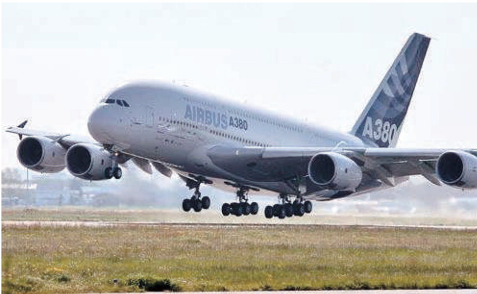
Сл.2.49 Дури и најголемите патнички авиони се изработуваат како нискокрилци: Airbus A380 при полетување
