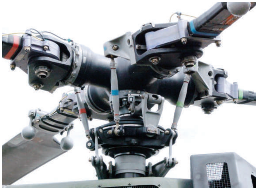
Сл.3.4 Глава на главниот ротор со лопатки и циклопрстен
