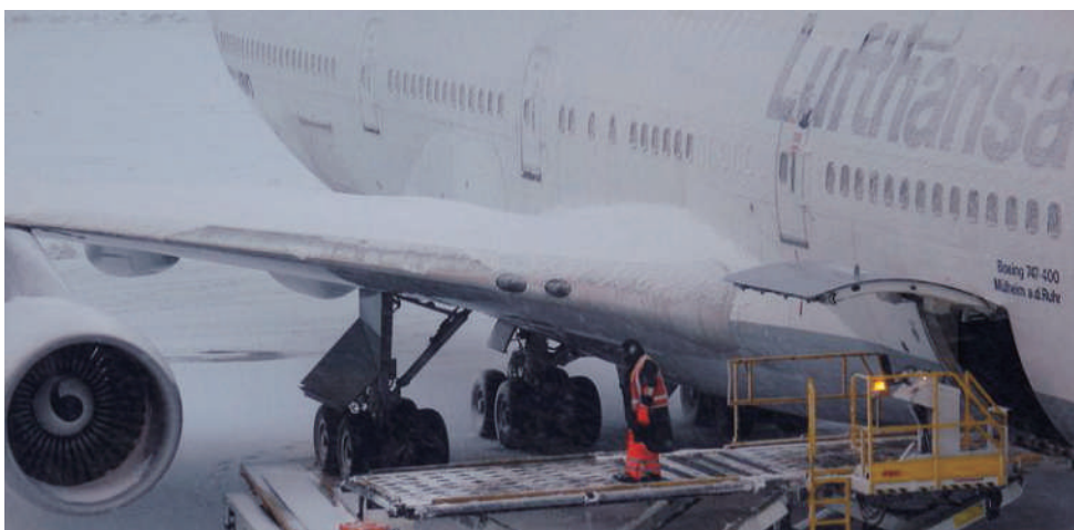
Сл. 2.45 Крило на голем авион покриено со дебелин слој снег - вовед во катастрофа
