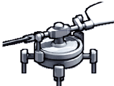
Поткренатата карданска плоча предизвикува намалување на колективниот чекор на лопатките
