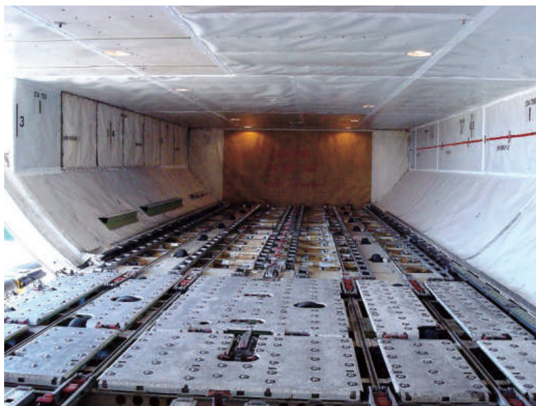
Сл.2.11 Преден понизок товарен оддел на Боинг 747. Подот е покриен со мобилен систем за манипулација (транспорт, товарење, истовар) со контејнери (ULDs).
