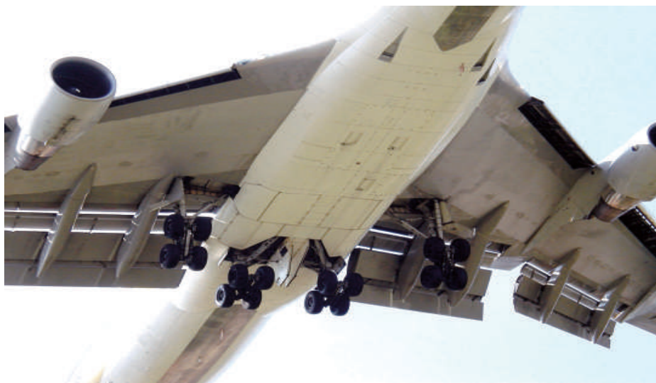
Сл.2.67 Уредите за хиперпотисок се применуваат и на најголемите авиони; Boeing 747 при слетување со напдно извлечени заткрилца
