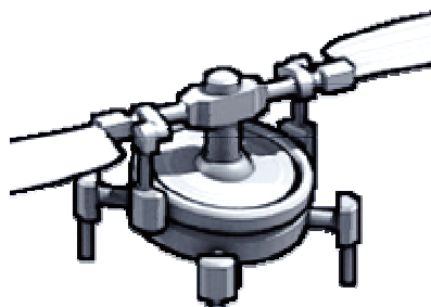
Наведнатата (закосена) карданска плоча воспоставува контрола и командување со цикличниот чекор на лопатките:
