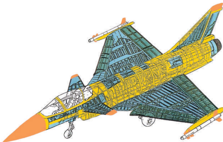
Сл.1.10 Примена на материјали при градба на современ суперсоничен авион: сино-С композити; зелено- саќе од С композити; кафеаво- титан; портокалово- кевлар; жолто- алуминиум и/или литиум; преостанатото-челик
