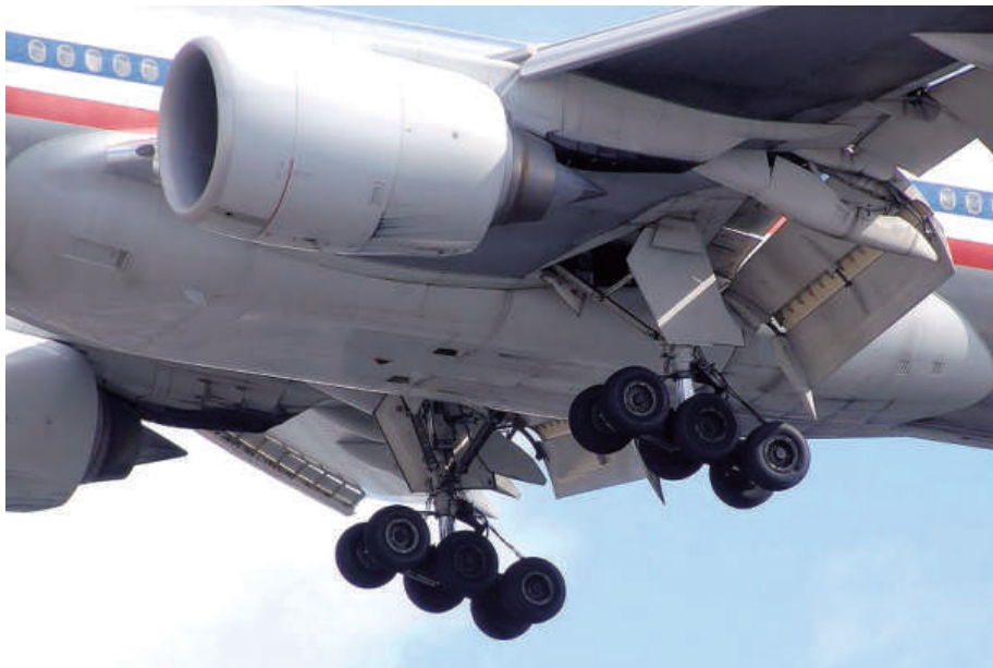
Сл.3.30 Boeing 777 неколку секунди пред слетување. Активирани се вовлечливиот главен стоен трап и комплетниот систем за хиперпотисок
