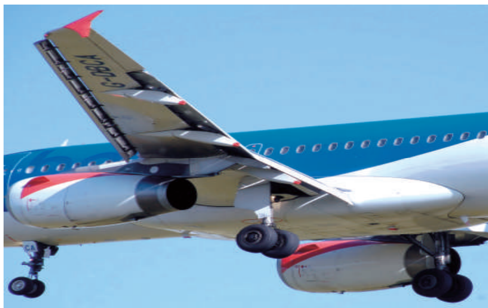
Сл.1.25 Целосно извлечени преткрилца и заткрилца кај Airbus A319
