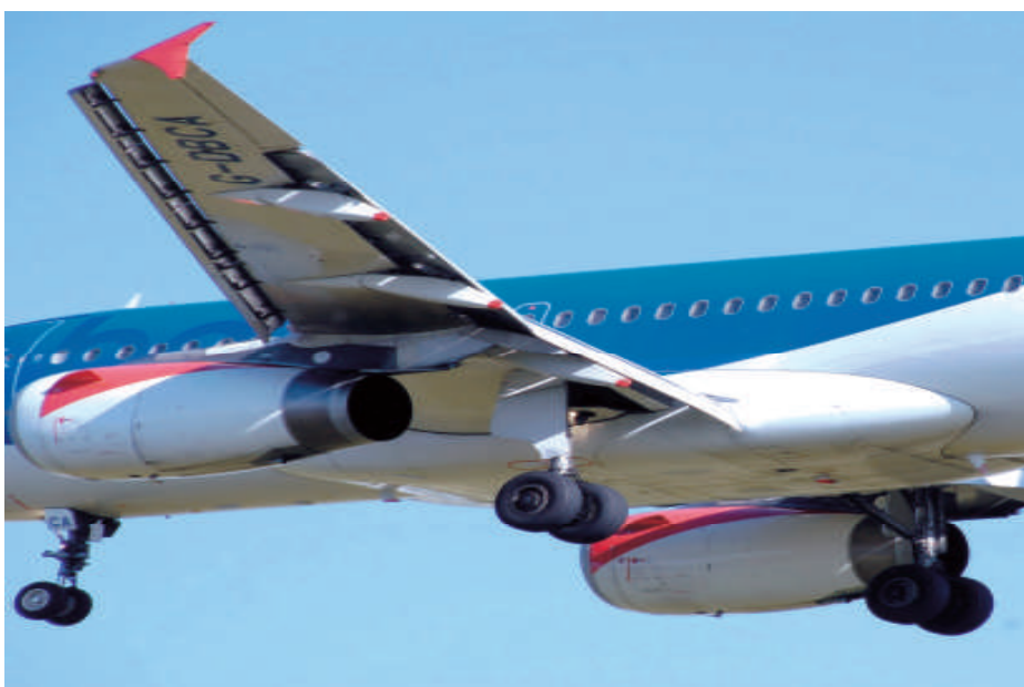
Сл.2.68 Целосно извлечени преткрилца и заткрилца кај Airbus A319
