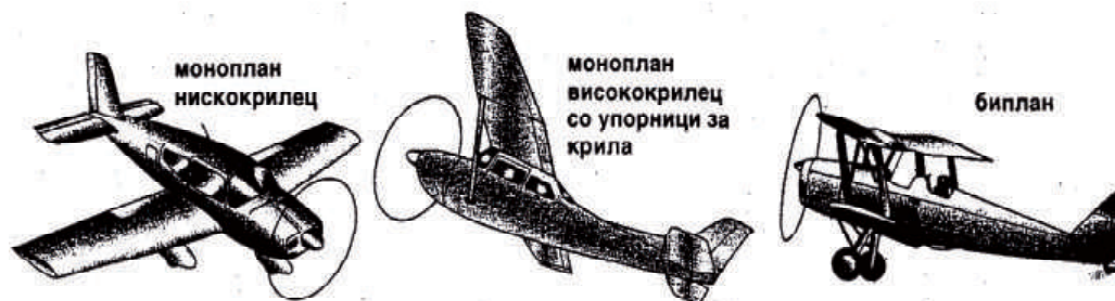
Сл.2.48 Концепти на авион според положбата на крилото
