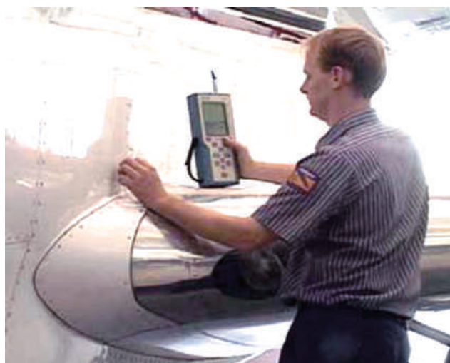
Сл.2.2 Испитување на носивата оплата на труп со ултразвук
