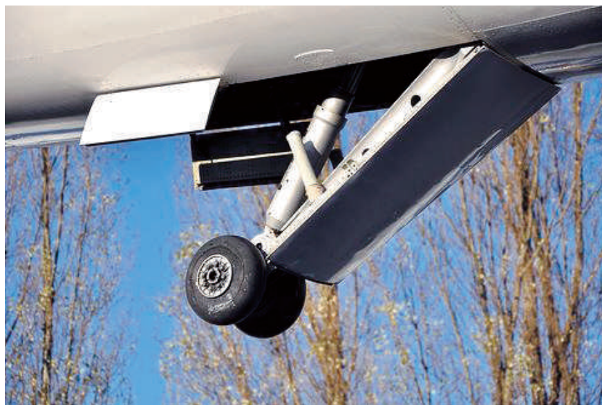
Сл.3.5 Опашно тркало кај суперсоничниот патнички авион Concorde
