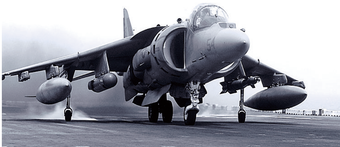
Сл. 3.6 Легендарниот борбен авион AV-8B Harrier поседува стоен трап тандем со две нозе во трупот и две конзолни нозе на крилата
