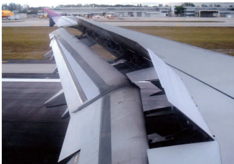
Сл.1. 24 Airbus A321 на приземјување со извлечени спојлери
