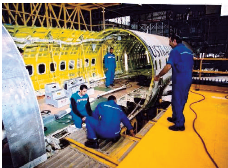
Сл.2.10 Изработка на труп на Boeing 737. Се гледаат елементите на структурата на трупот: ребрата, надолжниците, отворите за прозорци и подната конструкција
