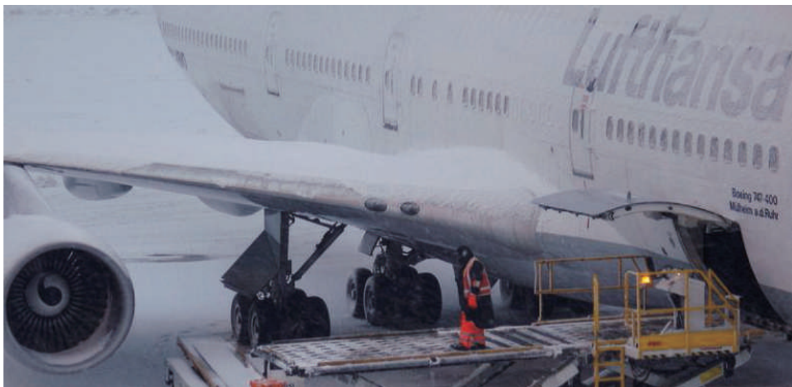
Сл.4.9 Крило на голем авион покриено со дебели слој снег - вовед во катастрофа
