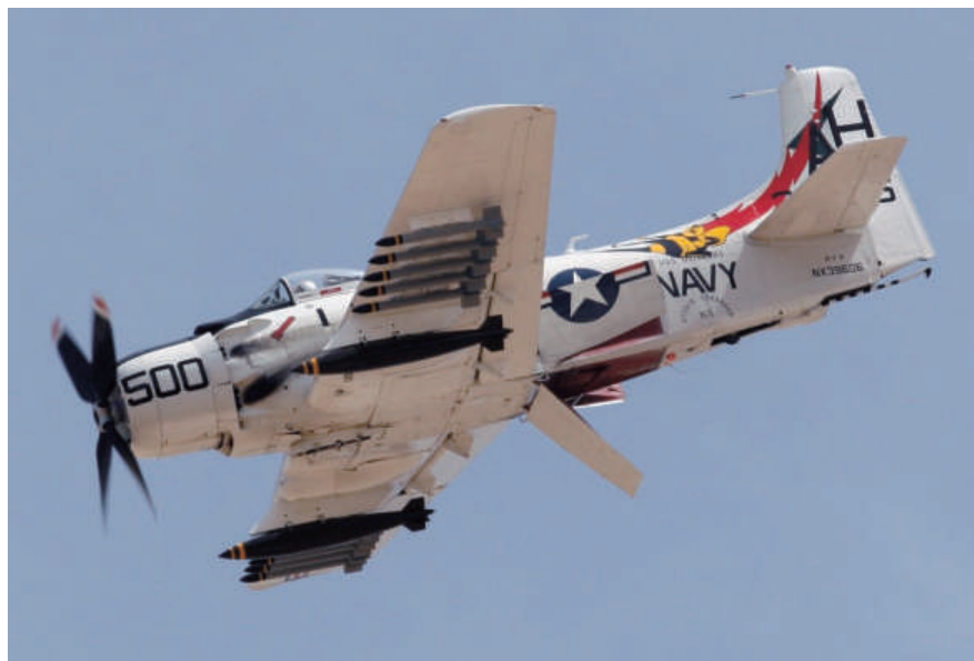
Сл.1.26 Авион А-1 при понирање со активирани воздушни кочници на трупот
