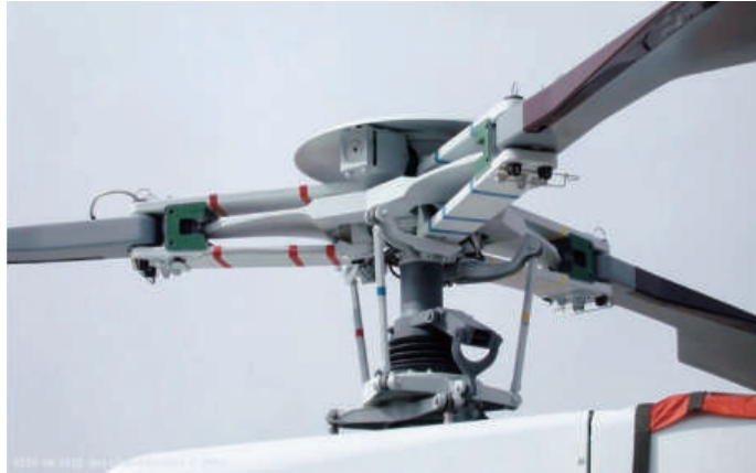
Сл.3.7 Трикрака роторска глава Starflex без зглобови и од композити, применета на Eurocopter AS355 Twin Star
