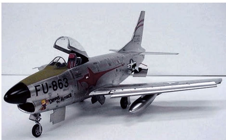
Сл. 1.27 Легендарниот F-86D Sabre , со извлечени автоматски преткрилца и воздушни сопирачки (во задниот дел на трупот)
