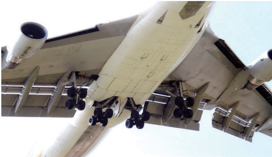
Сл.1.23 Уредите за хиперпотисок се применуваат и на најголемите авиони; Boeing 747 при слетување со целосно извлечени заткрилца
