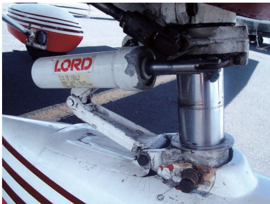
Сл.3.41 Пример за лошо одржување и корозија на виталните делови на еластичната нога
