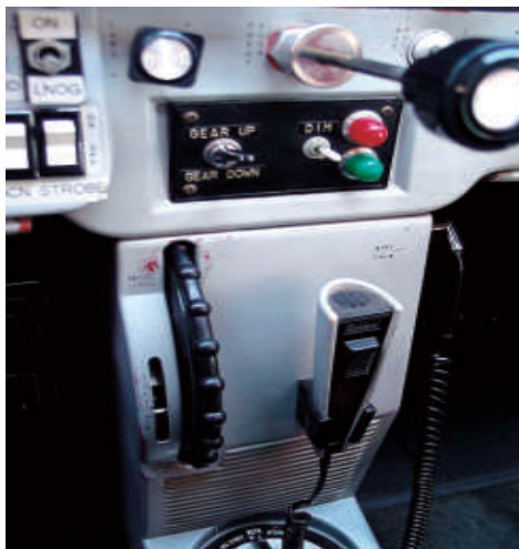
Сл.1.16 Централна конзола на лесен авион Cessna 172 - вертикалното црно тркало е команда на тример.
