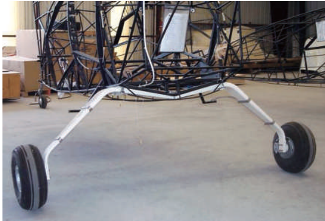
Сл.3.27 Едноставен стоен трап на лесен авион од дурална пружина
