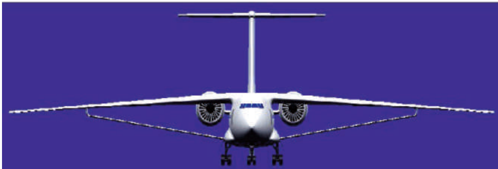
Сл.2.20 Концепт на современ авион висококрилец со крилни упорници
