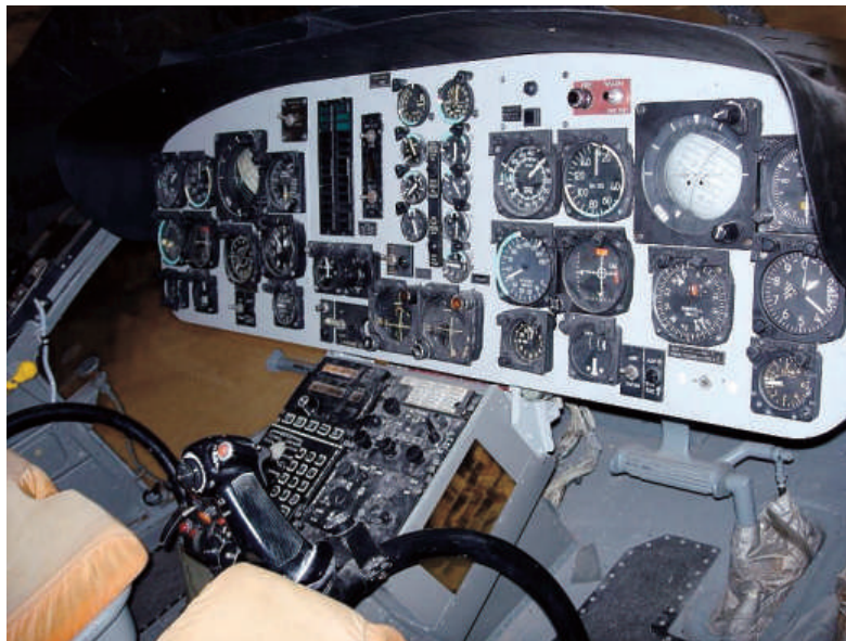
Сл.3.27 Изглед на инструменталната табла на еден современ хеликоптер
